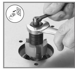
Figure 28. Tightening spindle nut.
